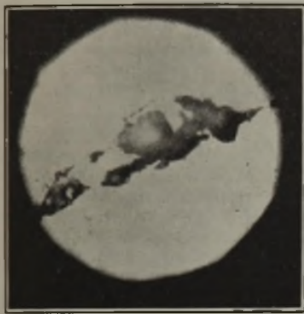
Abbildung 15a. Abbildung 15a und b. Glasiger Einschluss (Gießprobe). Ohne Nikols. Keine Helligkeitsänderung beim Drehen des Objektisches.
