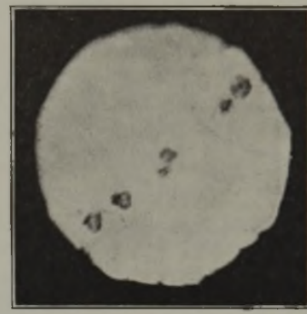
Abbildung 16. Kristalliner Einschluss. Veränderung der Helligkeit beim Drehen des Objektisches unter + - Nikols.
