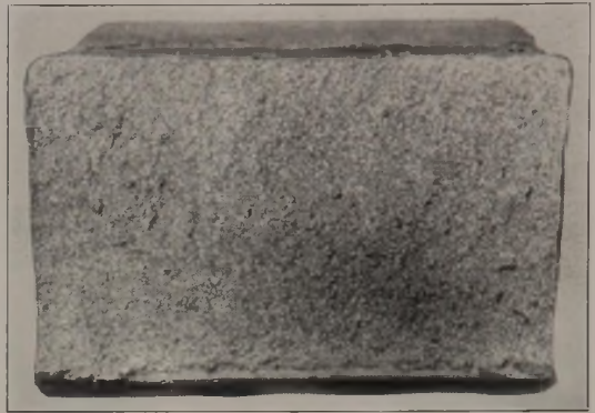
Abbildung 16. Kesselblech F, feinkörniges Bruchgefüge nach Ueberhitzung.
