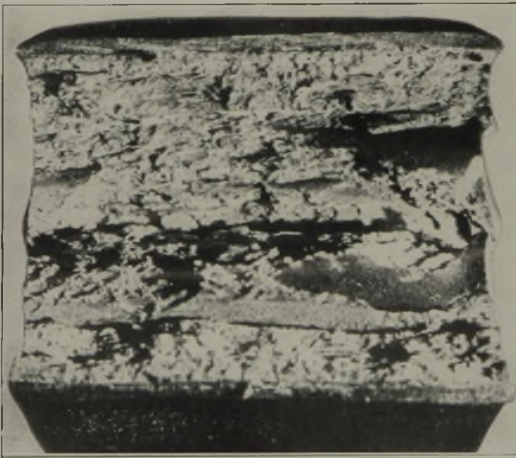
Abbildung 24. Kesselblech G, schlecht verschweißte Gasblase beim Kerbbiegebruch aufgerissen.
