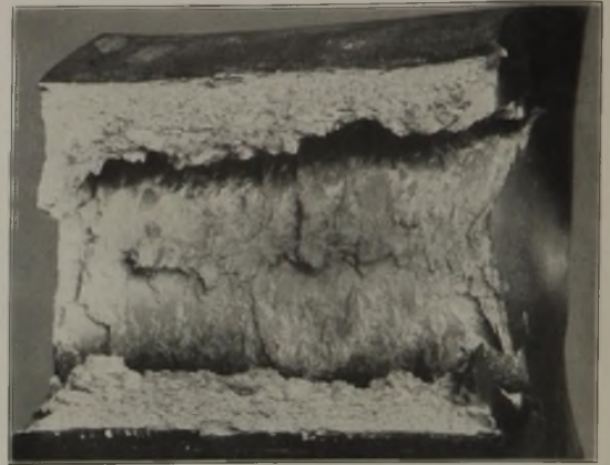
Abbildung 12. Kesselblech F (alterungsbeständig, beruhigt vergossen). Bruchgefüge zähfaserig, die Probe ist beiderseits längs aufgerissen.
