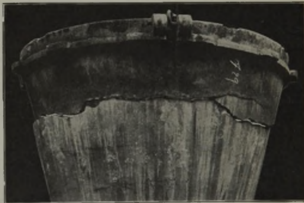
Abbildung 1. Rißbildung bei einer Schlackenpfanne.
