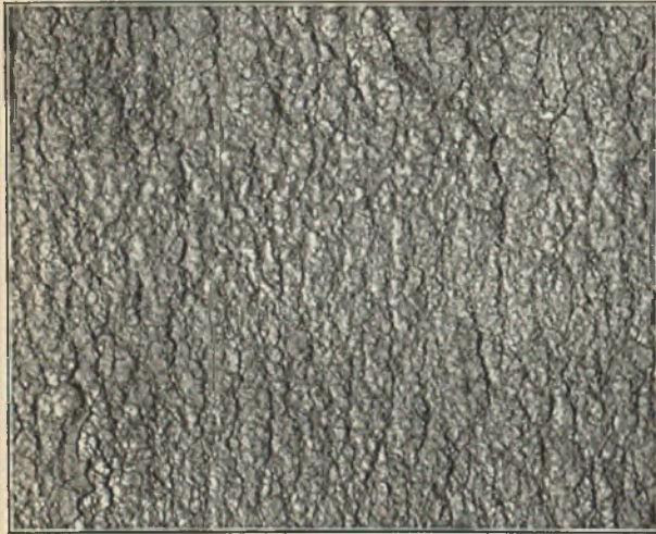
Abbildung 6. Oberfläche einer gewalzten Trommel aus Stahl mit 0,85 % Cu.
