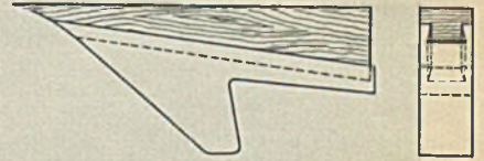
Abbildung 15. Hund mit auswechselbarer Lauffläche aus Hartholz.
