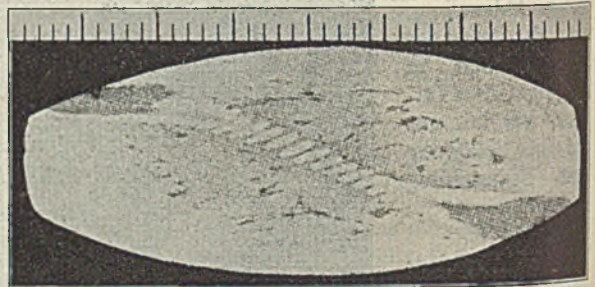
Abbildung 6. Schraube im Oval bei diagonaler Lage im Ausgangsquadrat, nach N. Metz: Arch. Eisenhüttenwes. 1 (1927/28) S. 193/204.
