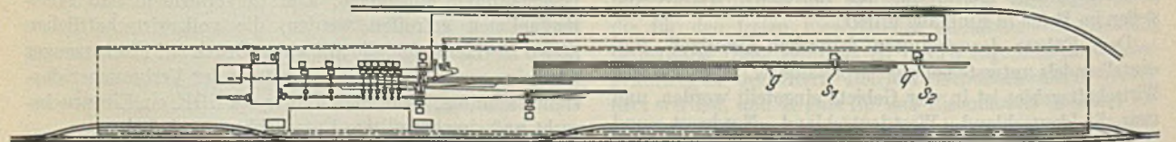
Abbildung 2. Halbkontinuierliche Stab- und Drahtstraße mit versetzten Zwischengerüsten und einer viergerüstigen Zickzack-Duostraße.
