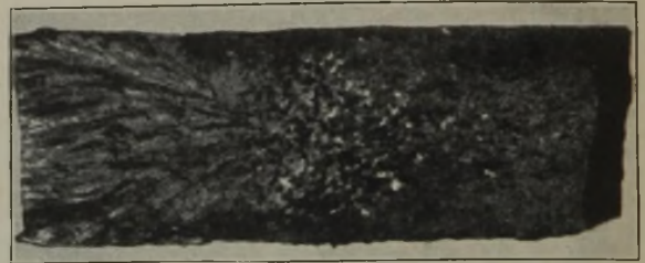
Abbildung 13. Bruch von Schalenhartguß.
