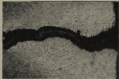
Abbildung 10. Rißbildung bei einem Stahl mit 2 % W, 8 % Mo und 1,2 % V infolge Entkohlung der Oberfläche.
