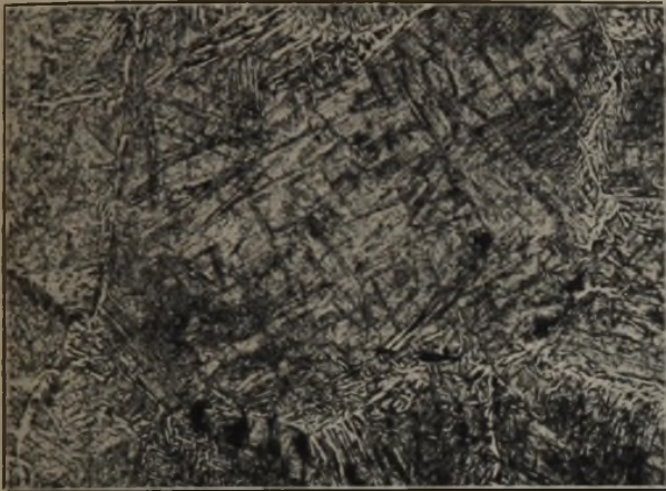
Abbildung 1. Martensitnester im Uebergang von Schweißverbindungen an St 52.
