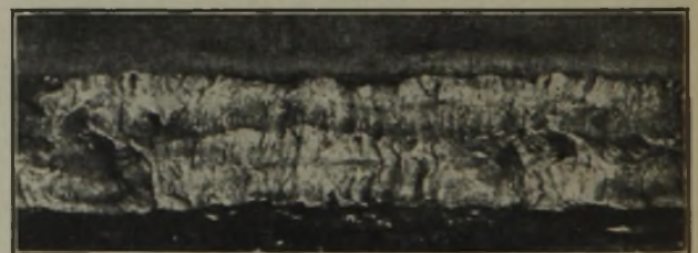
Abbildung 4. Bruchgefüge an der Rißstelle.
