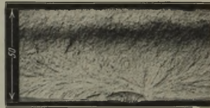
Abbildung 6. Bruchbild einer Biegeprobe aus Stahl St 52 mit aufgeschweißter Längsnaht.
