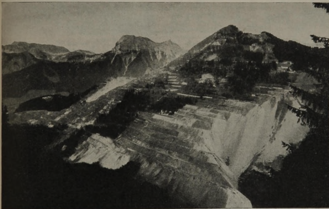
Abbildung 1. Gesamtansicht des Steirischen Erzberges (1534 m) mit den 60 Abbaustufen zu je etwa 12 m Höhe. Links der Pfaffenstein (1871 m).
