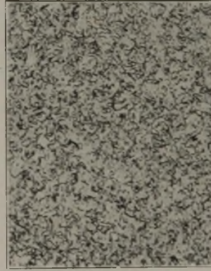
Abb. 3. Von 850° in Oel abgelöscht, 2 h bei 700° geglüht, Ofenabkühlung.
