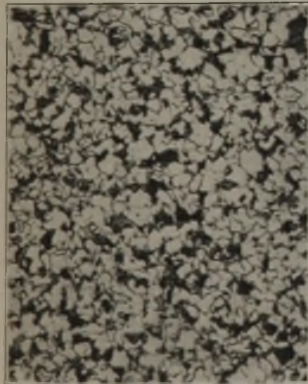
Abb. 1. 2 h bei 700° geglüht, Ofenabkühlung.
