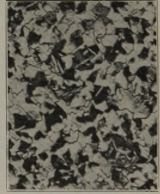
Abb. 4. 1 h bei 950° geglüht, auf 600° schnell abgekühlt, 2 h bei 600° geglüht, in Oel abgelöscht.
