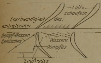
Bild 8. Erklärung der Tropfenschlagwirkung auf dem Rücken der Dampfturbinschaufeln bei wasserhaltigem Dampf.
