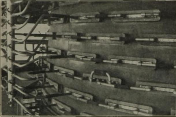
Bild 3. Anordnung der Kühlkästen; Einlaufseite.
