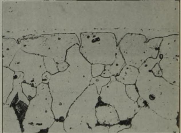
Bild 11. Schlib durch ein mit austenitischem Chrom-Nickel-Stahl plattiertes Stahlblech.
