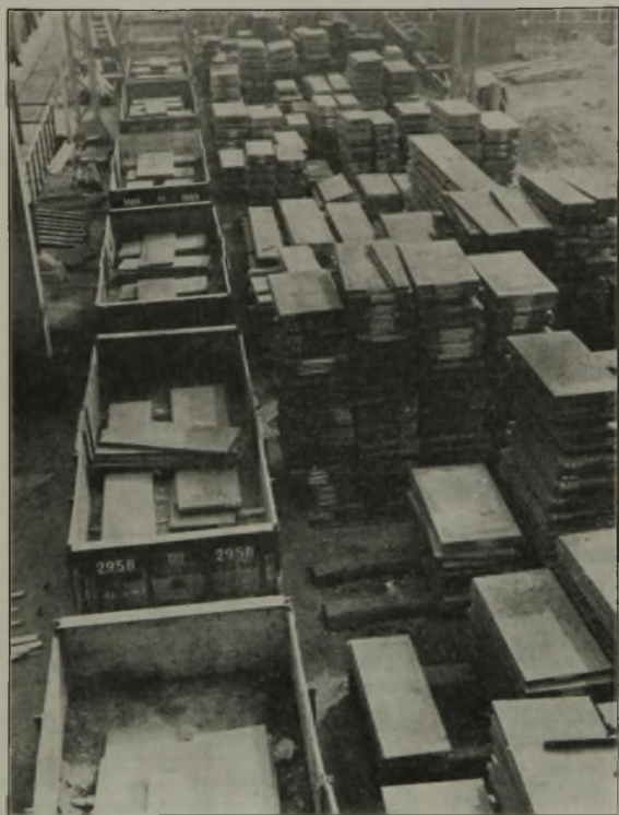
Bild 9. Brammenlager der Breitbandstraße.
