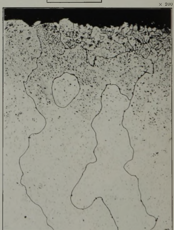
Bilder 37 bis 40. Einwirkung des Feuchtigkeitsgehaltes bei Glühung von Chrom-Molybdän-Stahl. ( 1 \text{ kg/cm}^2 \text{ H}_2 , 750^\circ , 100 h.)
