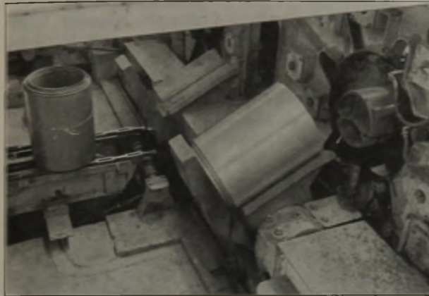
Bild 16. Bundeabbeförderung der Breitbandstraße.
