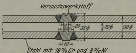
Bild 15. Versuchsanordnung für Wasserstoffdiffusions-Versuche.
