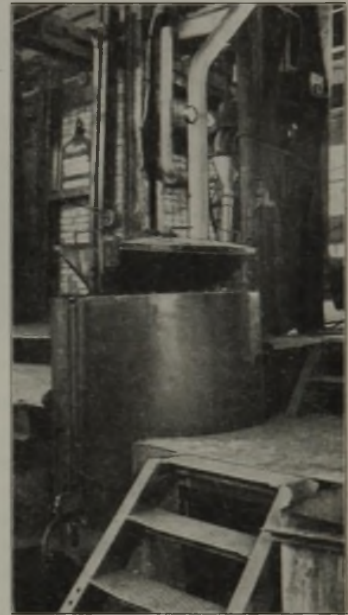
Bild 5. Pechschmelzbehälter und Zubehör.
