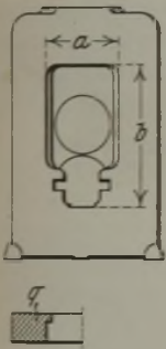
Bild 1. Warmwalzenständer für Weißbleche alter Bauart.
