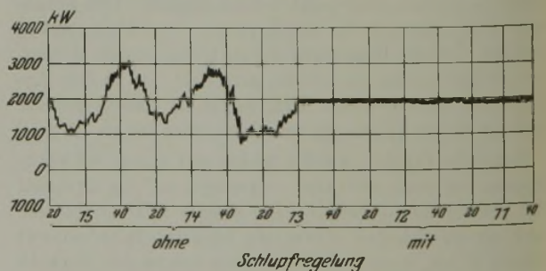
Bild 4. Leistungsaufnahme des Antriebsmotors eines Iglernantriebes für Blockstraße, ohne und mit selbsttätiger Schlupfregelung.
