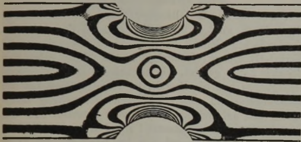
Bild 5. Isochromatenbild eines gebogenen Flachstabes mit Halbkreiskerben (nach M. M. Frocht).
