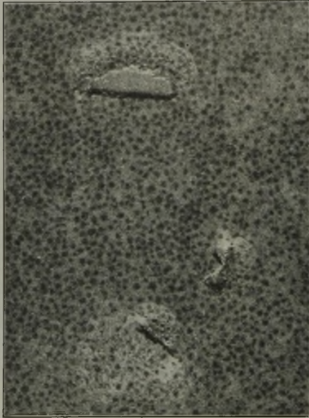
Bild 14. Fischschuppe bis zum Blech durchgehend. Grundemail H, Blech kaltgewalzt. (× 4)
