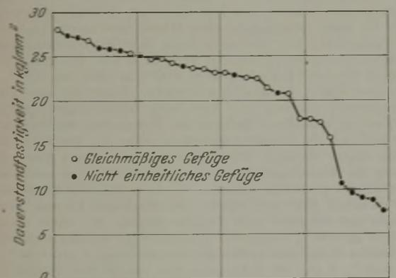
Bild 4. Streuung in den Ergebnissen von Dauerstandversuchen von S. H. Weaver an Chrom-Nickel-Molybdän-Stahl derselben Zusammensetzung bei 450°.
