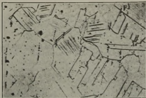
Bild 2. Nach Abschrecken von 1250° in Wasser.
