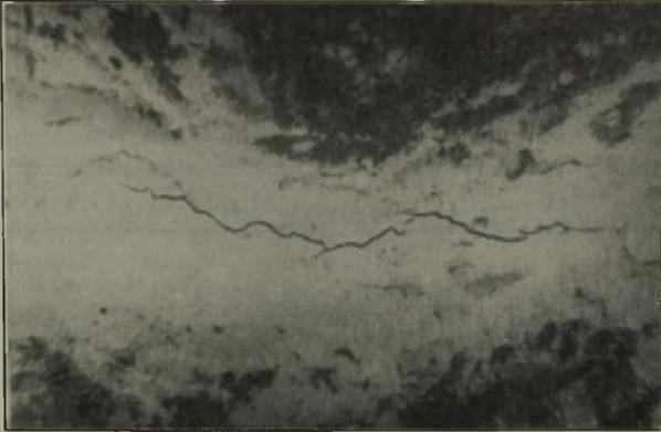
Bild 2. Magnetpulveranzeige eines Risses in einem Stahlgußgehäuse. (x 1.)
