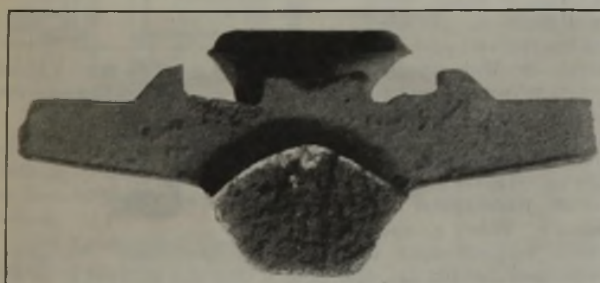
Bild 13. Tempergußstück, nach Bild 11 und 12, getempert. (Nach H. Jungbluth.)
