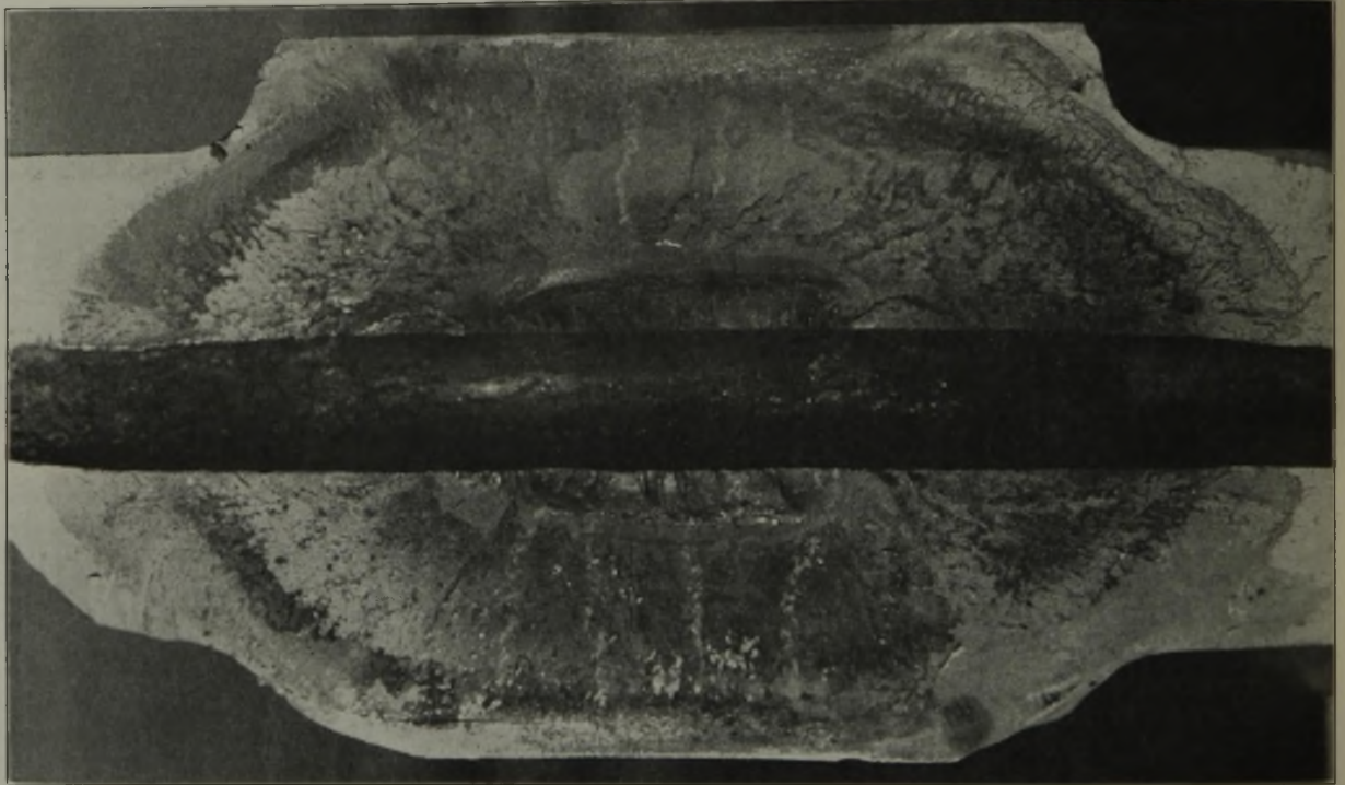
Bild 7. Dauerbruch infolge von Anrissen von der Bohrung aus. (Walze aus Duogerüst.)
