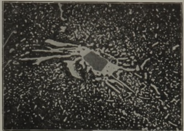
Bild 10. Schlacke und Karbidanreicherungen an einer muscheligen Stelle. (Geätzt mit Salpetersäure; × 500.)
