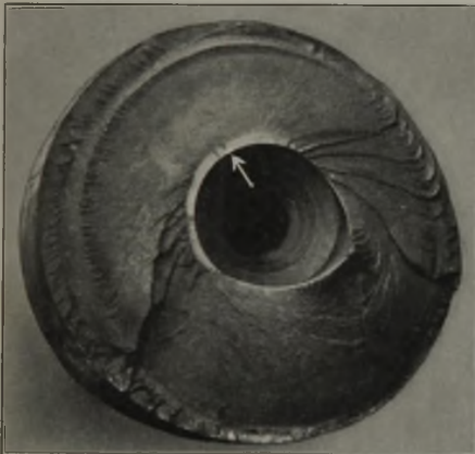
Bild 1 und 2. Querdauerbrüche infolge von Absätzen in den Bohrungen.
