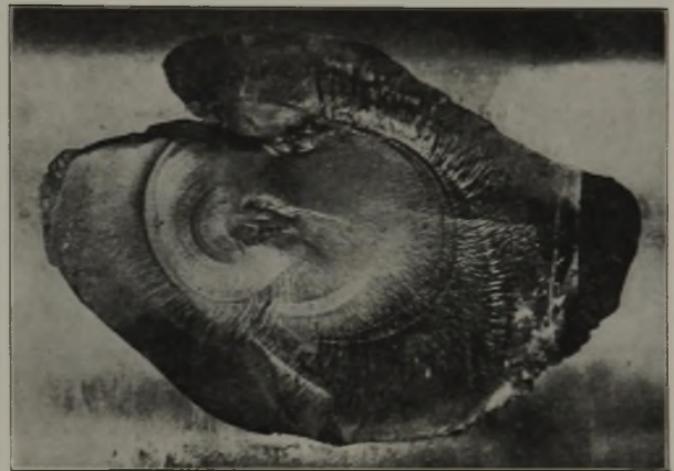
Bild 18. Ausplatzung aus einer Walze als Folge eines Dauerbruches durch Unterdruckstehenlassen der Walzen.
