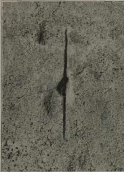
Bild 36. Zusammenhang zwischen Randblase und Spannungsriß an einem Zinkkessel aus Stahlguß. (rd. \times 0,75 .)
