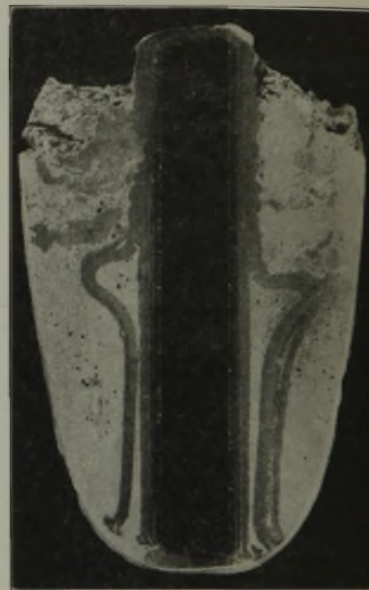
Bild 21. Stahlprobe im Blei-Zink-Bad 120 h auf 475° gehalten. (rd. × 1.)
