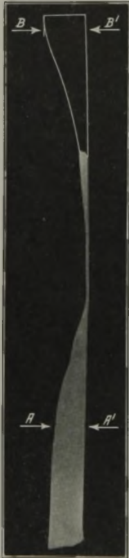
Bild 27. Schnitt durch den oberen Teil einer ausgelaufenen Zinkwanne. (rd. \times 0,3 .)
