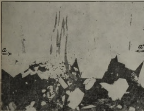
Bild 16. Silikatische Einschlüsse in Schweißstahl, vom Zinkbad nicht reduziert. (a—a' = Grenze Eisen-Hartzink.) (rd. \times 75 .)
