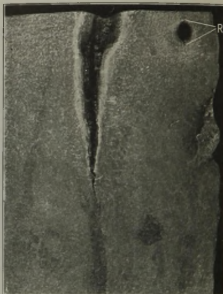
Bild 34. Rißbildung in einem Stahlguß-Zinkkessel. (rd. \times 0,8 .)
