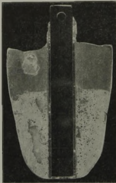
Bild 20. Stahlprobe im Blei-Zink-Bad 120 h auf 450° gehalten. (rd. × 1.)
