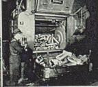
ROTOBLAST BARREL AIR BLAST ROOM
