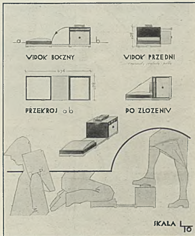
Ryc. 22. Stanisław Słowikowski (Warszawa). Projekt konkursowy Nr. 5 urządzenia do czyszczenia butów. Grupa VI. Nagroda I.
