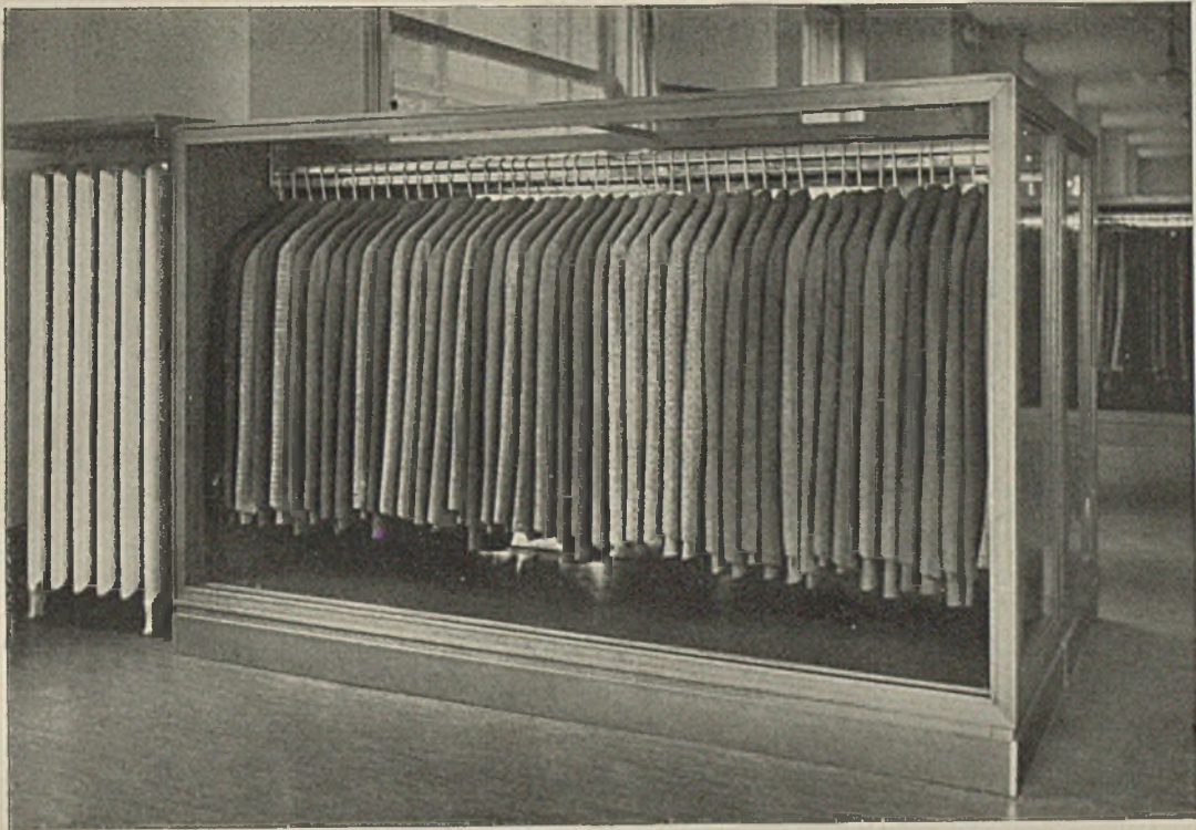
Serienregal für Anzüge, Ober- und Schmalseiten verglast. Stange besondere Konstruktion für große Belastung mit starken Flacheisenverbindungen in das an sich schwach konstruierte Holzregal einmontiert. Unten Serientisch und Stuhl
