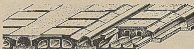
Perspektivische Darstellung der Stahlrohrbetondecken-Konstruktion
