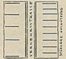
Abb. 5. Bestimmte Verbauungsart nach der Kompositionslinie bei neuzeitl. Aufschließung
