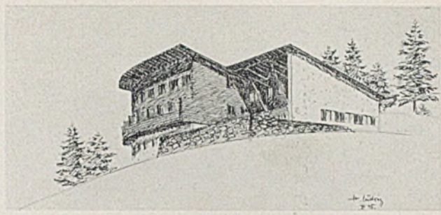
Ansichten des Sporthotels. Variante mit Außenwänden in Holz-Blockbauweise
