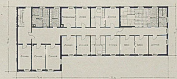
Grundriß des Obergeschosses im Maßstab 1:500
