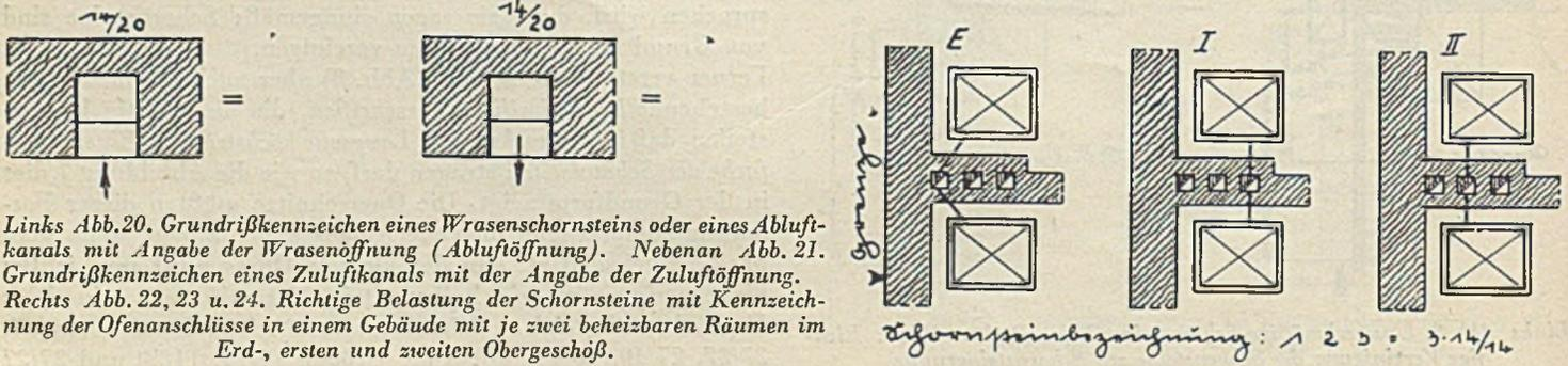
Links Abb. 20. Grundrißkennzeichen eines Wrasenschornsteins oder eines Abluftkanals mit Angabe der Wrasenöffnung (Abluftöffnung). Neben Abb. 21. Grundrißkennzeichen eines Zulufikanals mit der Angabe der Zuluftöffnung. Rechts Abb. 22, 23 u. 24. Richtige Belastung der Schornsteine mit Kennzeichnung der Ofenanschlüsse in einem Gebäude mit je zwei beheizbaren Räumen im Erd-, ersten und zweiten Obergeschoß.
