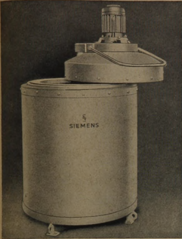
Schachtöfen mit Luftumwälzung zum Anlassen von Stählen 28 kW 650°
