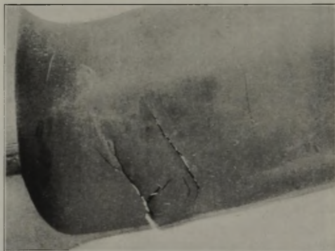
Bild 16. Risse in der Laufschaufel einer Turbine durch Spannungskorrosion.
