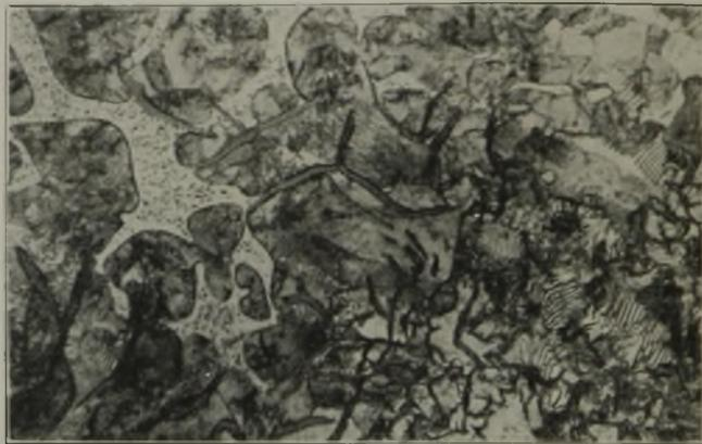
Bild 11. Feingefüge eines Kolbenrings des Rolls-Royce „Merlin“-X-Motors (geätzt mit alkoholischer Salpetersäurelösung).
