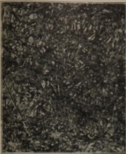
Bild 1. Martensit im Rande des Einsatzstahles ECMo 100.
