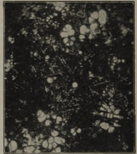
Bild 12. Verschieden abgekühlte Thomasslacken. ( \times 100 )
