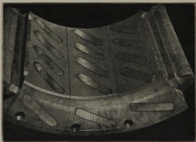
Bild 2 a. Feinblech-Warmwalzenlager mit Sondergußeisen-Ausfütterung und Rotgußspiegeln.
