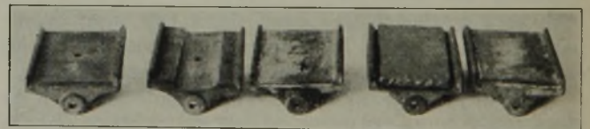
Bild 9. Gußeiserne Schleifschuhe für Stromabnehmer.
