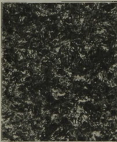
Bild 2a nach unmittelbarer Walzhärtung von 730°
