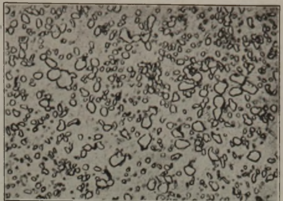
Bild 6. Glühgefüge bei Luftabkühlung von 850 auf 750°.
