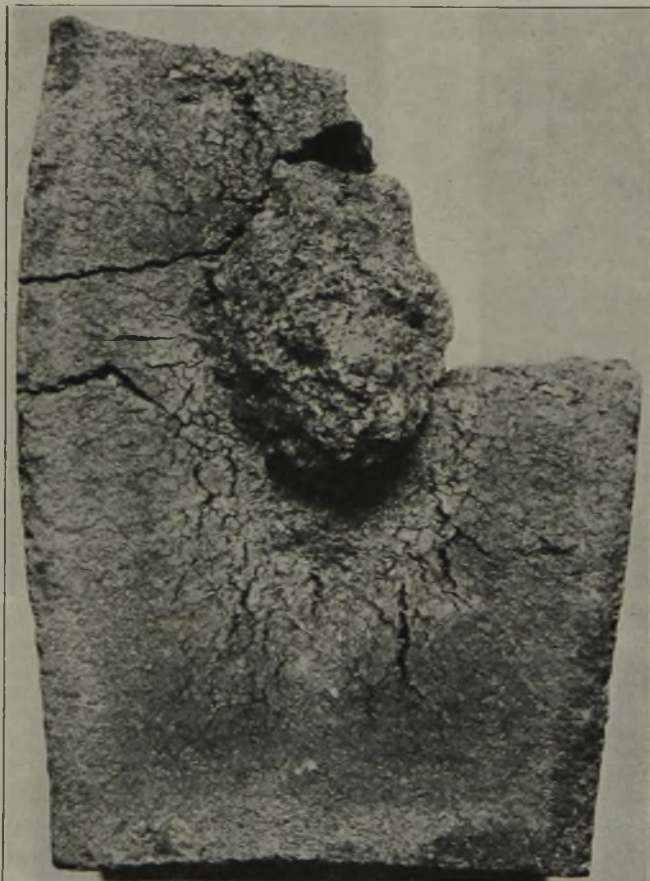
Bild 6. Zertreiben und Schmelzen eines Klinkersteines bei 1100^{\circ} .
