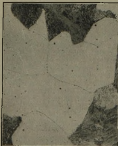
Bild 10. 1100°/Ofen, 2 h 580°/Luft. Bild 11. 1100°/Bleibad von 400° 2 h, 2 h 600°/Luft. Bild 12. 1100°/Eiswasser, 2 h 650°/Luft. Bilder 10 bis 12. Vergütungsgefüge des Stahles Cr 1 mit 0,18% C und 1% Cr nach Umwandlung in der Perlitstufe (Bild 10), Zwischenstufe (Bild 11) und Martensitstufe (Bild 12). (× 500; getzt mit alkoholischer Pikrinsäure.)
