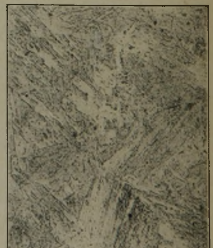
Bild 10. 1100°/Ofen, 2 h 580°/Luft. Bild 11. 1100°/Bleibad von 400° 2 h, 2 h 600°/Luft. Bild 12. 1100°/Eiswasser, 2 h 650°/Luft. Bilder 10 bis 12. Vergütungsgefüge des Stahles Cr 1 mit 0,18% C und 1% Cr nach Umwandlung in der Perlitstufe (Bild 10), Zwischenstufe (Bild 11) und Martensitstufe (Bild 12). (× 500; getzt mit alkoholischer Pikrinsäure.)
