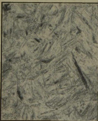
Bild 16. Stahl Cr 18 mit 0.25 % C und 4.6 % Cr nach Abkühlen von 950 ° in Luft.
