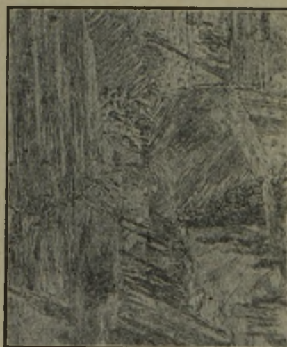
Bild 17. Stahl Cr 11 mit 0.21 % C und 0.5 % Cr nach Abschrecken von 1100 ° in Wasser.
