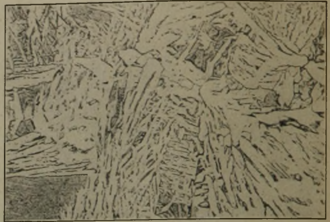
Bild 9. Zwischenstufengefüge von Stahl C 4 mit 0,14% C nach Abschrecken von 1100° in Öl. (× 500; getzt mit alkoholischer Pikrinsäure.)
