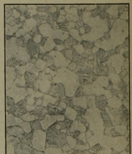
Bild 18. Stahl Mo 6 mit 0.04 % C und 2.7 % Mo nach Abschrecken von 950 ° in Eiswasser.
