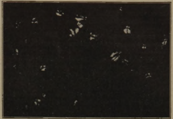
Bild 15. Optisch aktive Einschlüsse, 1480 °, 150 s. Magnesitausguß; Unterguß.
