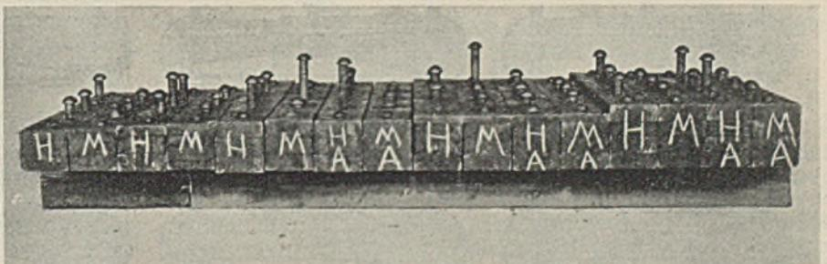
Abb. 7. Die wieder in die Löcher gesteckten Niete aus gewöhnlichem Nietstahl. Die am schlechtesten gestauchten Niete gehen wieder ganz ins Nietloch hinein.
