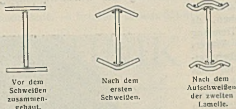
Abb. 12. Darstellung der Verbiegungen beim Schweißen eines Trägers von 860 mm Höhe.
