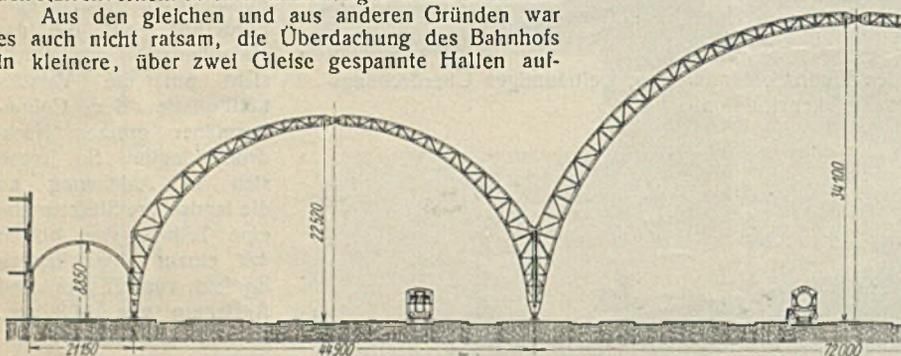
Abb. 1. Querschnitt der Bahnhofshalle Mailand.
