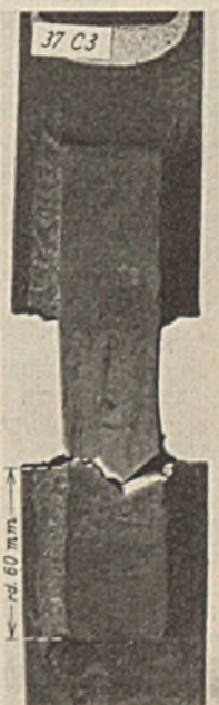
Abb. 13. Zerstrung durch statische Belastung.
