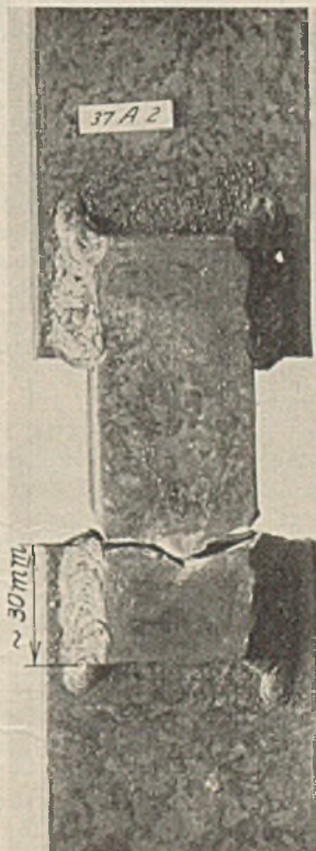
Abb. 12. Zerstrung durch wechselnde Belastung.
