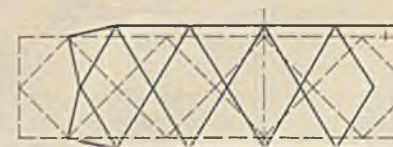
Abb. 1 bis 3. Systemverformungen bei gleicher Verkürzung der Gurte und Gelenkigkeit der Knotenpunkte.
