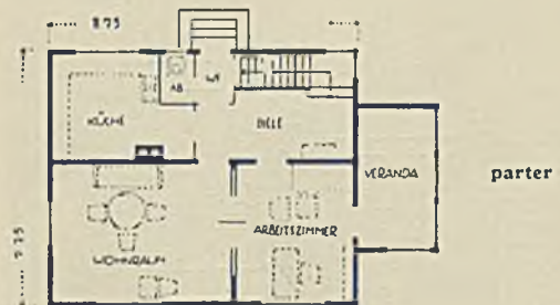
Arch. Aug. Schwemme. Dom drewniany typu H. 444' masowej produkcji z osiedla Leubnitz-Neuostera pod Dreznem.
